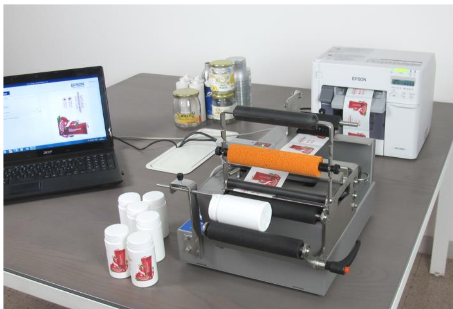
Pk-52 connesso a EPSON TM-C3500 stampa e applica etichette a colori con inchiostri resistenti a polimeri. Tutto in un solo passaggio, anche fronte/retro in piena autonomia.
